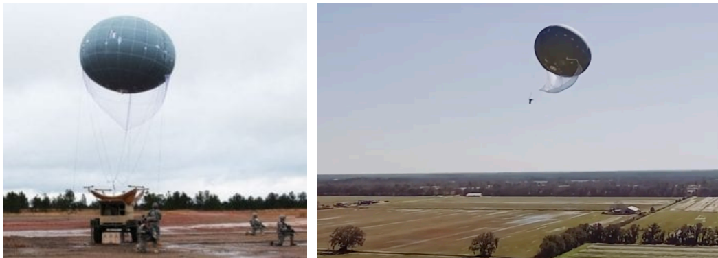
Fig. 17. Een testvlucht met een WASP (Winch Aerostat Small Platform), een verplaatsbare kabelballon van de Amerikaanse Drone Aviation Corp die voor communicatie- en bewakingsdoeleinden wordt ingezet (foto's: https://www.unmannedsystemstechnology.com/company/drone-aviation-corp/ ).
