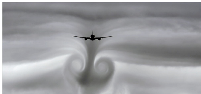
Fig 51: Turbulentie achter een vliegtuig (wake turbulence) zichtbaar gemaakt door dichte stratusbewolking (bron: http://www.nytimes.com/2007/06/12/business/12turbulence.html ).
