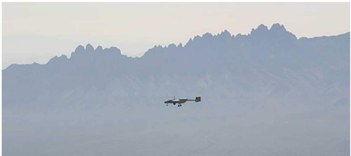
Fig. 15: De Aerostar, een nieuwere versie van de B-Hunter met een spitsere neus en zonder de ronde antenne bovenaan. Foto gevonden op http://www.airforce-technology.com/projects/aerostar UAV/ .
